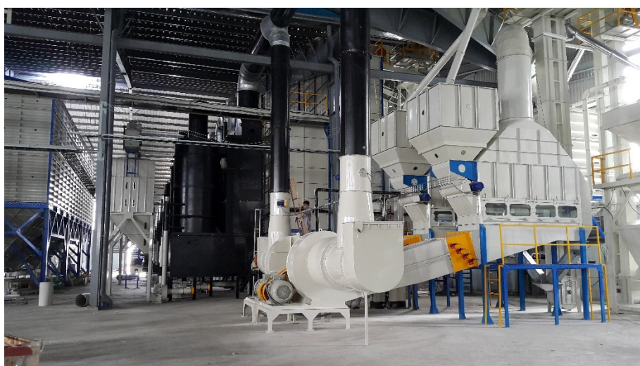
Hình 13 Máy sấy tầng sôi MSTS 15 tấn/ giờ:dùng để xử lý lúa
