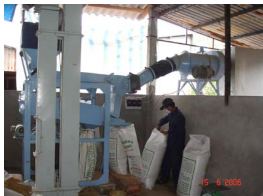
Hình 7: Quạt MF 0.5-100-2900 liên hợp với cyclone HT dùng cho máy làm sạch lúa.
