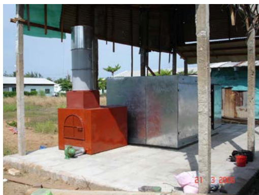
Hình 6: Quạt MF 1-30-1450 + TA với miệng hút lắp hướng lên trên nhằm giảm độ ồn. <80dB(A)
