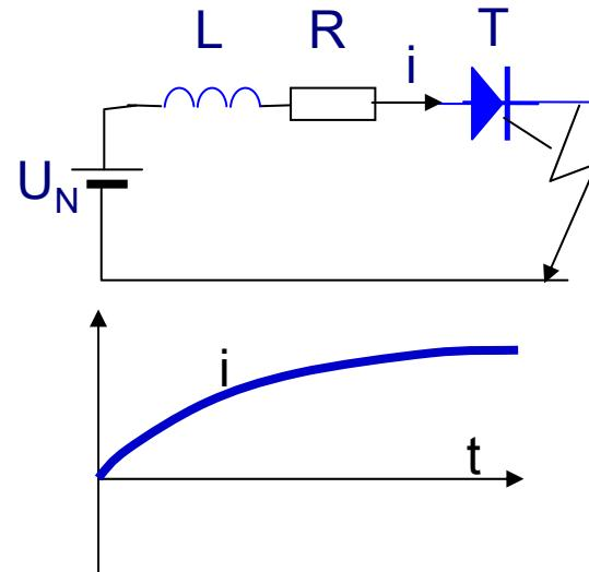
$$i = I_{bd} e^{-\frac{t}{T_{dt}}} + I_{XL} \left( 1 - e^{-\frac{t}{T_{dt}}} \right)$$
