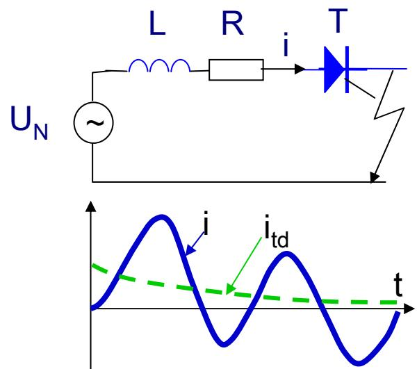
$$i = \frac{U_m}{Z} \sin(\omega t - \varphi) + I_0 e^{-\frac{t}{T_{dt}}}$$
