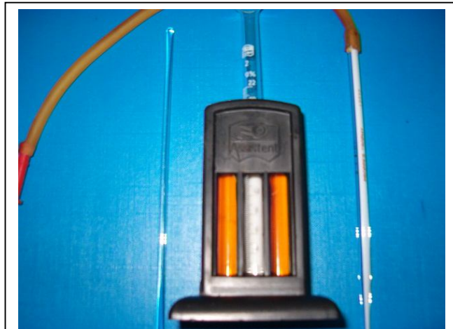
H.5 Bộ huyết sắc kế Sahli (bao gồm 1 pipette, 1 ống nghiệm, 1 thìa khuấy và 1 hộp so màu)
