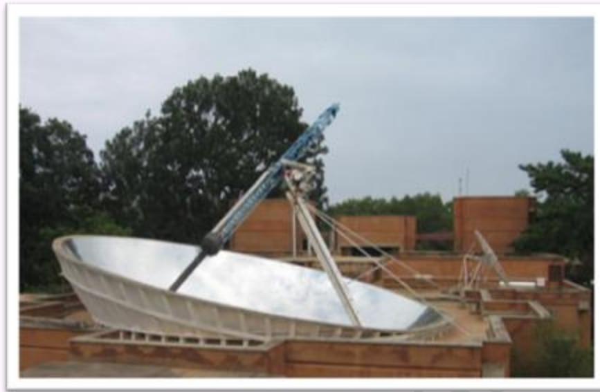
Hình: Bát năng lượng mặt trời tại Auroville, Ấn Độ tập trung ánh sáng mặt trời trên một bộ thu lưu động để sản xuất hơi cho nấu ăn.
