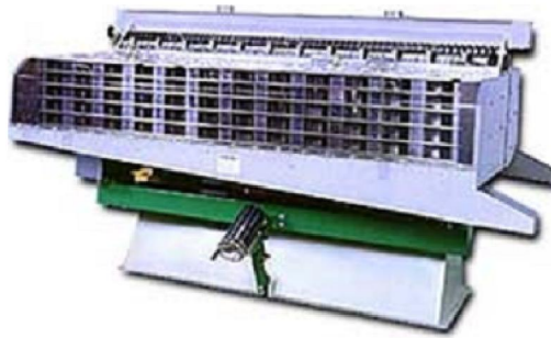
Hình 3.24. Sơ đồ máy tách lúa gạo kiểu zig zag
