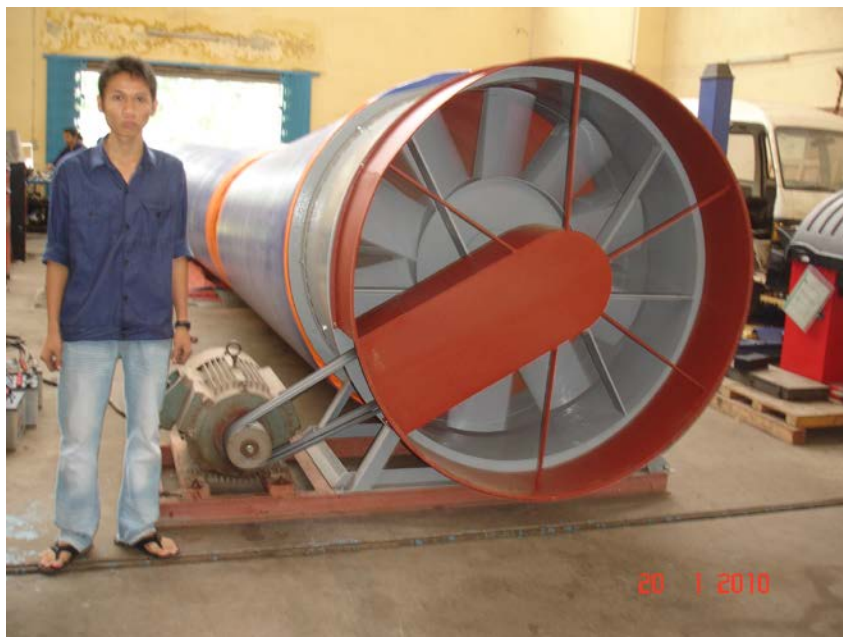
Hình 18: Quạt HT 1500 (truyền động đai) lắp với ống khảo nghiệm quạt
