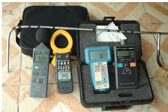
Hình 16: Các dụng cụ đo: ống pitot, dụng cụ đo độ ồn, công suất, tĩnh áp, số vòng quay
