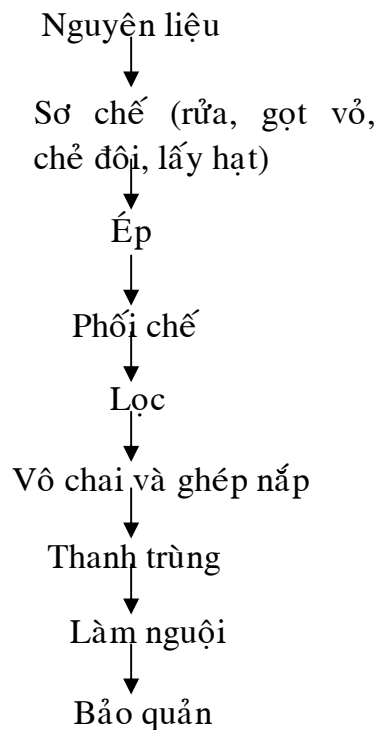
Hình 5: Quy trình chế biến nước trái cây
