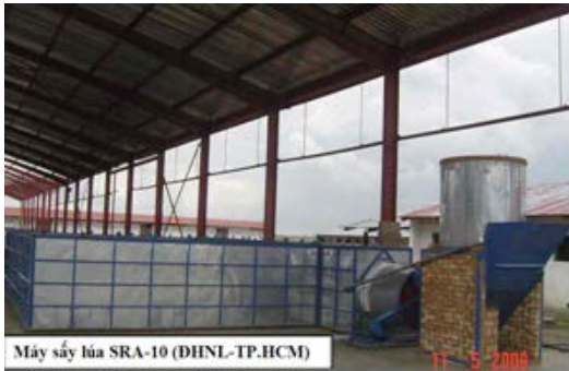
Máy sấy lúa SRA-10 kiểu lắp ghép ở Tanzania (Châu Phi)
