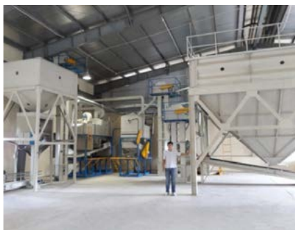
Máy sấy lúa giống 40 tấn/mẻ và dây chuyền chế biến 2,5 tấn/giờ
