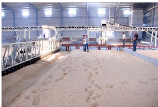
Hệ thống máy sấy lúa vĩ ngang Tương đương máy sấy tháp
