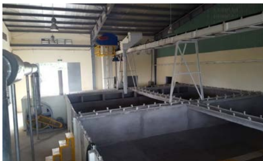
Máy sấy lúa giống 40 tấn/mẻ và dây chuyền chế biến 2,5 tấn/giờ
